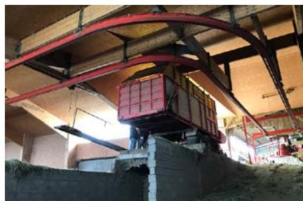
La griffe est portée par un système de poutres métalliques pouvant être soulevées pour libérer l'espace pendant le chantier de fauche.
