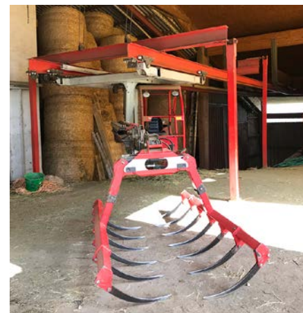
La griffe est portée par un système de poutres métalliques pouvant être soulevées pour libérer l'espace pendant le chantier de fauche.
