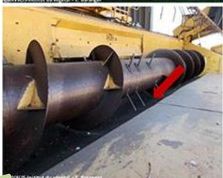
3 Ouvrir et vider le bac à pierre sous le convoyeur
